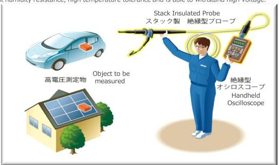
※プローブ黄色線は絶縁部分。被測定物及び測定機器が大地から離れている場合、絶縁型プローブを使用しないと測定者の体を電流が流れ感電する恐れがあります。また、被測定物のアースが取れていない状態で、接地型の測定器を使うと、絶縁型プローブを使用していても、感電や計測機器等を破損してしまう可能性があるので絶対に避けてください。
