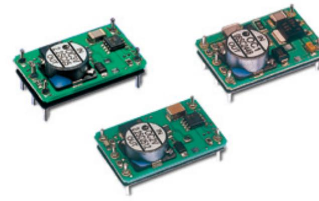
スイッチング式の非絶縁降圧DC/DCです。スイッチング方式のため、従来の三端子レギュレータ等では問題となった熱設計が解消。発振周波数固定、ワイド入力(10.2~32V、20.4~56V)、リモートコントロール機能(OC1)、出力可変機能(OC2、OC3)など使い勝手の良さを追求しています。
