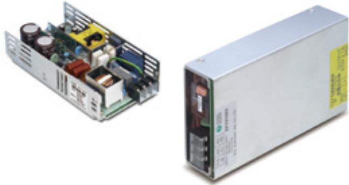
ETシリーズ用のPFCユニット (力率改善) のフロントエンドです。テスラコンバータと組み合わせることでAC/DCとして効率90%以上が可能です。EFYはAC100V入力時は351W、AC200V入力時は777Wまで自然空冷が可能。(強制空冷であればAC100V入力時777Wまで可能。)EPFはトータルコストを抑えたオープンフレームタイプです。AC100V入力時は400W、AC240V入力時は630Wまで自然空冷で使用可能です。
