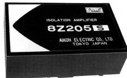
絶縁アンプは2段複合アンプで一般的に電圧出力形の絶縁アンプの場合、入力部、出力部の双方で利得のプログラムを行うことが出来ますが、温度ドリフト、リップル等を考慮して原則的に入力側で大きく利得を調整します。本器入力アンプ(A<sub>1</sub>)には低ドリフト、低オフセットのOP(μPC254A)が使用されており微小信号に対して大きな利得を設定することが出来ます。〔図5.1〕は本器の基本接続である。伝送比をKとしたとき入力e<sub>i</sub>と出力E<sub>0</sub>の関係は
