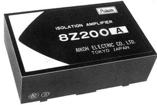
8Z-200は耐圧と外形寸法を別にすれば、電気的特性、ブロック図ともに5Z-20と殆んど同様であります。伝送比0.993、オフセット電圧±10mV以下(±2mV typ.)で目的と他の周辺回路の関係によっては帰還抵抗15Kのみでも使用出来ます。このときの代表的な入、出力特性は次の通りである。
