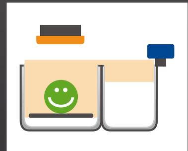
⑥粉の中に造形物が埋まった状態で造形が完了します。
